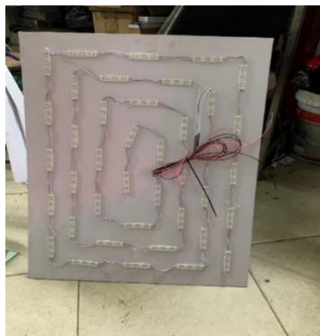
Ảnh 4. Bóng đèn Led gắn vào mặt trong hộp đèn
